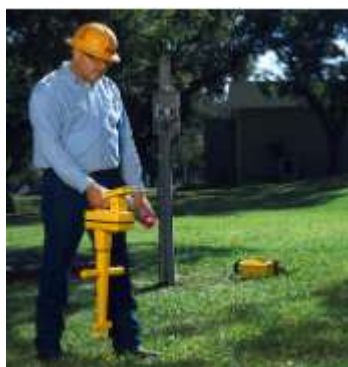
Rys. 40. Lokalizowanie i pomiar głębokości znaczników elektromagnetycznych
