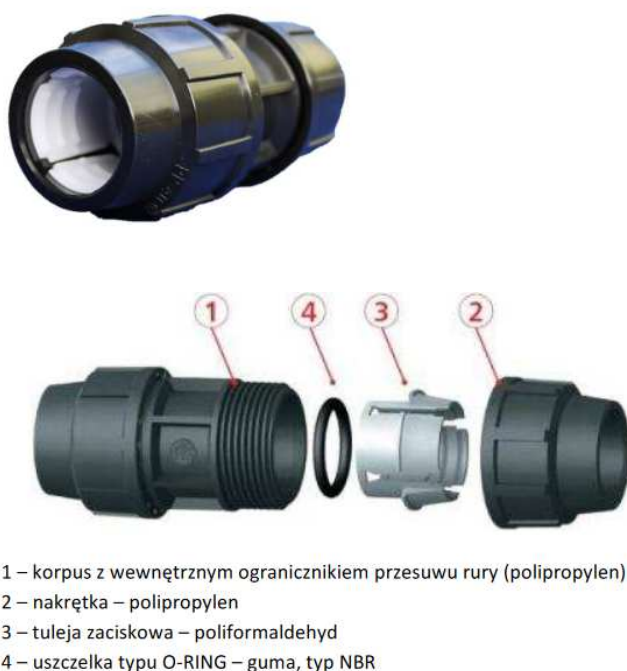
Rys. 23. Przykład złączki skręcanej do rury światłowodowej
