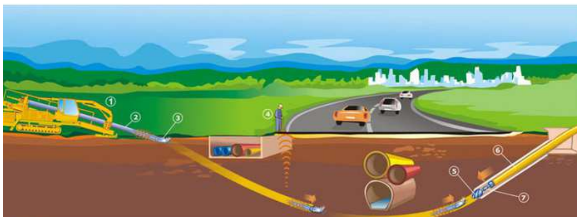
Rys. 29. Wykonywanie otworów pod kanalizację kablową metodą przewiertu
